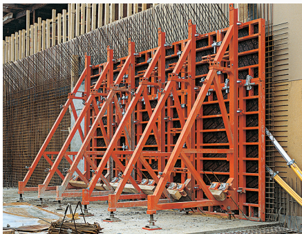
Kozły oporowe SB-B i SB-C w połączeniu z deskowaniem TRIO, wysokość betonowania 3,50 m.
