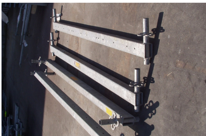
33.20.52 Brak trzpienia przesuwnego
