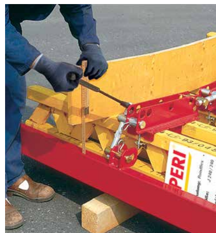
Trzpień nastawczy do regulacji profili brzegowych jest również obsługiwany kluczem Combi.
